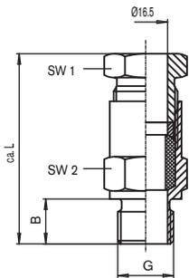
**Verschiebbare Gewindemuffen, gasdicht bis 1 bar aus Werkstoff 1.0711
