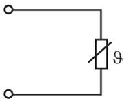
Die Verbindung zwischen Auswertelektronik und Thermometer erfolgt mit einer zweiadrigen Leitung. Wie jeder andere elektrische Leiter besitzt auch diese einen Widerstand, der dem Widerstandsthermometer in Reihe geschaltet ist. Damit addieren sich die beiden Widerstände, was von der Elektronik als höhere Temperatur interpretiert wird. Bei größeren Entfernungen kann der Leitungswiderstand einige Ohm betragen und eine beachtliche Verfälschung des Messwertes verursachen.
