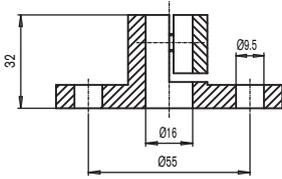
**Anschlagflansch nach DIN 43734**
